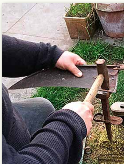
Het haren van het zeismes met haarhamer en haarspit. Hier is het haarspit in een blok hout geklopt, maar te velde prik je dat gewoon in de grond. Foto: Kristof Vanhee.
