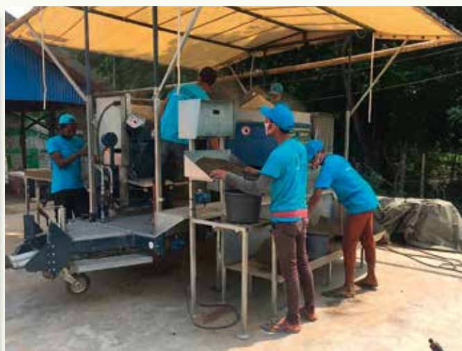
Links een traditionele steenbakkerij in Bangladesh, rechts de persmachine waarmee de ecostenen gemaakt worden.
